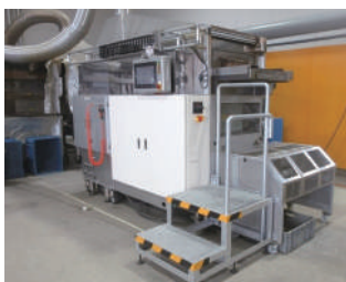
ヒートセパレーター (基盤のはんだを溶かし、部品を剥離する装置)
