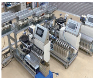
Aセレクトター (画像認識を使用したAIによる部品選別装置)
