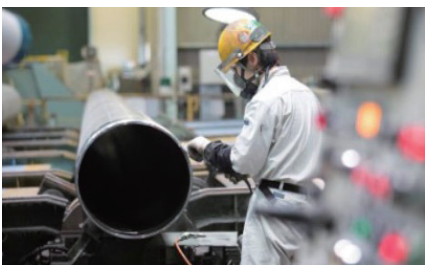
鋼管表面の検査・加工
